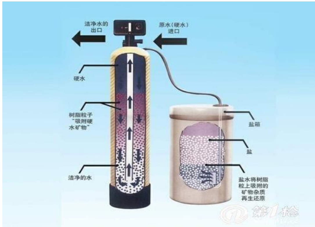
图 4-1 全自动软水器工作原理示意图
