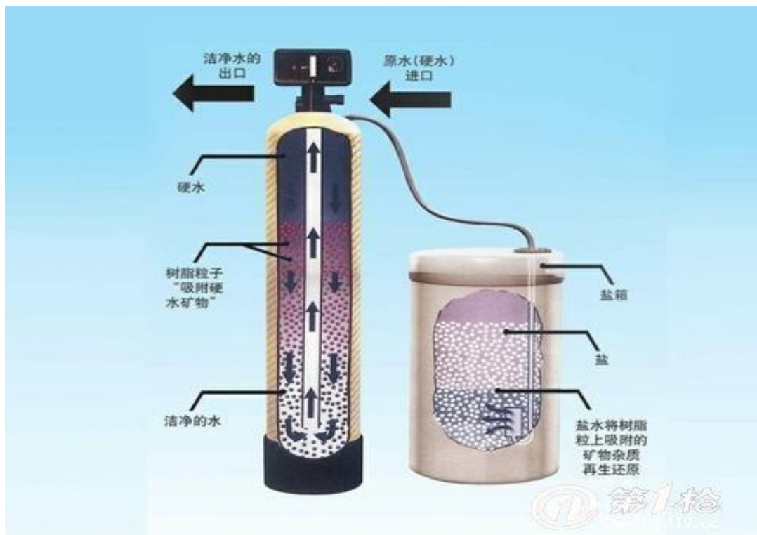
图 2-4 全自动软水器运行原理示意图
